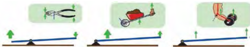
شکل ۱۳: بر اساس محل قرار گرفتن تکیه‌گاه می‌توان اهرم‌ها را به سه دسته تقسیم‌بندی کرد.
